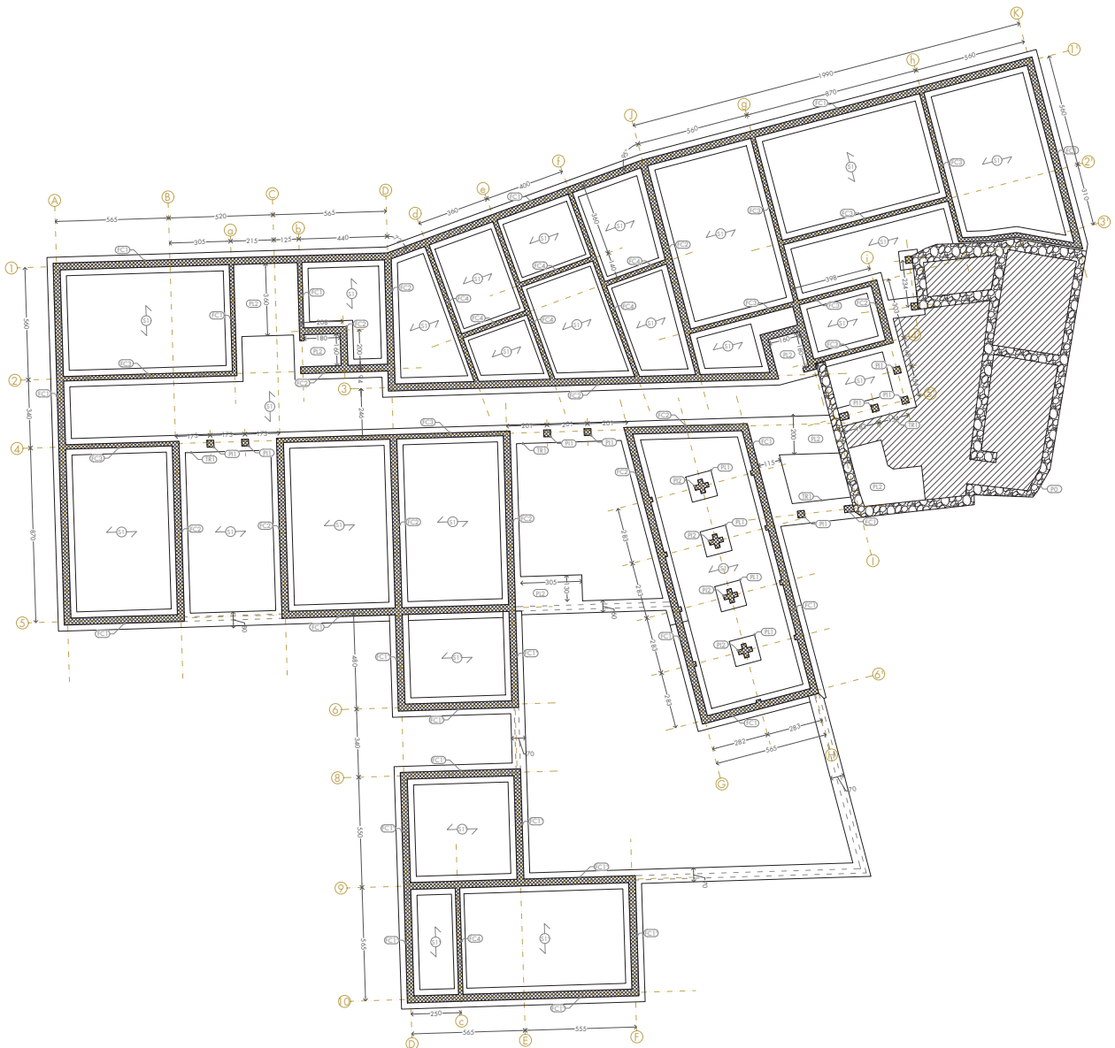
Fig. VII-18. Pianta strutturale delle fondazione. Scala 1/300
