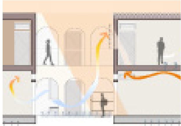
Fig. VIII-13. Ventilazione nella scuola Al-Nuri
