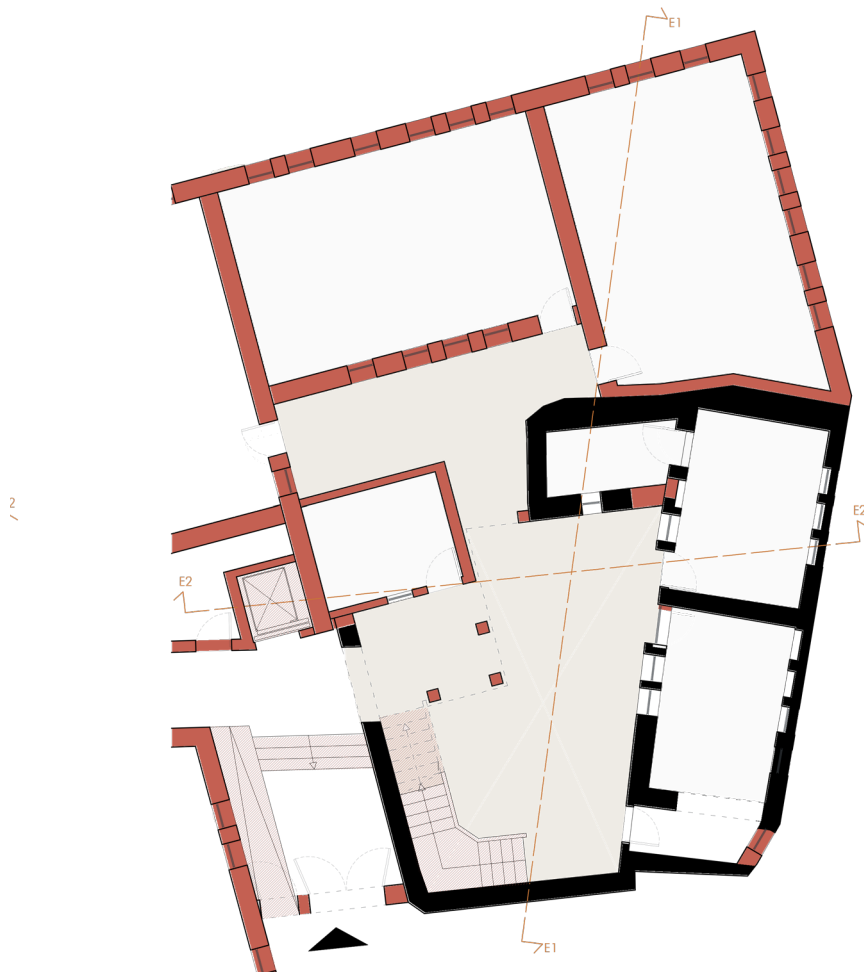
Fig. IV-77. Interventi di costruzione al piano terra | Scala 1/200
