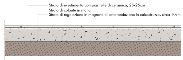
Fig. IV-59. Chiusura orizzontale a terra. Scala 1/20
