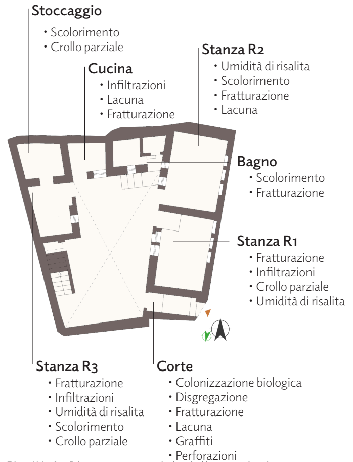
Fig. IV-61. Riassunto spaziale delle patologie | Scala 1/250
